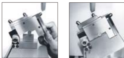
縦のダイヤ60°横のダイヤ30°に成形 ヘッドが30°の場合に平行ドレッサとして使用
